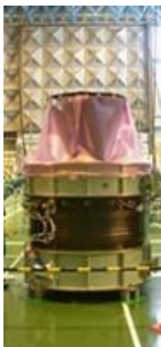
3段モータ(写真はノズルアップ)
