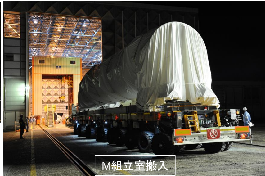
1段モータ輸送・搬入の状況
