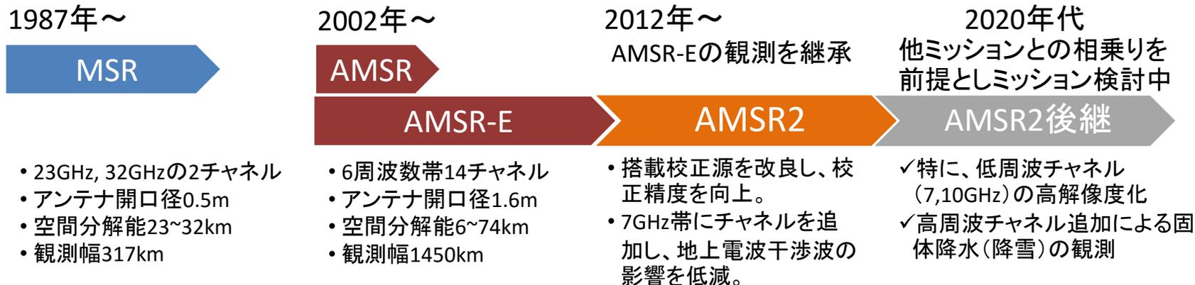
観測センサ(AMSR2)は、米国Aqua衛星搭載のAMSR-Eとの観測継続性を図り、可能な範囲で既存技術を活用。校正精度向上や信頼性向上の目的に絞って設計変更を実施。
