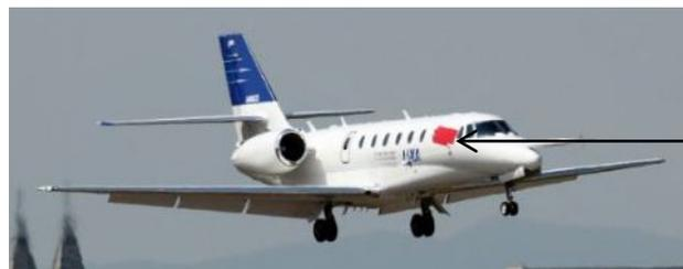
実験用航空機「飛翔」を用いたリブレット飛行実証試験
