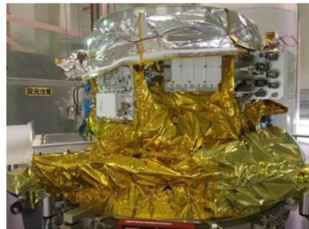
第3段機器搭載構造
