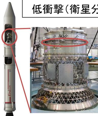
非火工品デバイスをトリガとし、リンクによりボルト拘束解除
