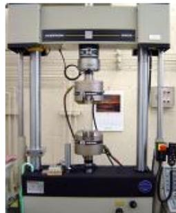
油圧荷重疲労試験機の一例
