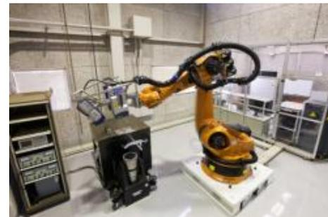
多軸振動非接触自動計測システム
