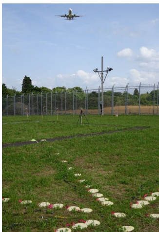
成田空港での測定の様子と計測した音源分布
