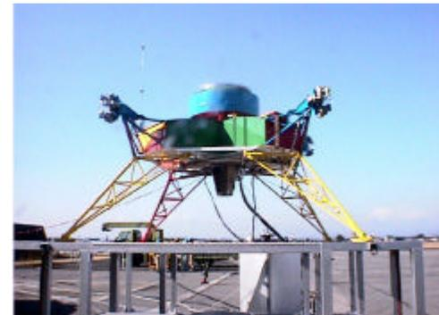
月面軟着陸フェーズの一部を模擬することができる、フライング・テストベッド(FTB)と呼ぶ垂直に上昇・降下飛行が可能な試験装置を製作・飛行実験
