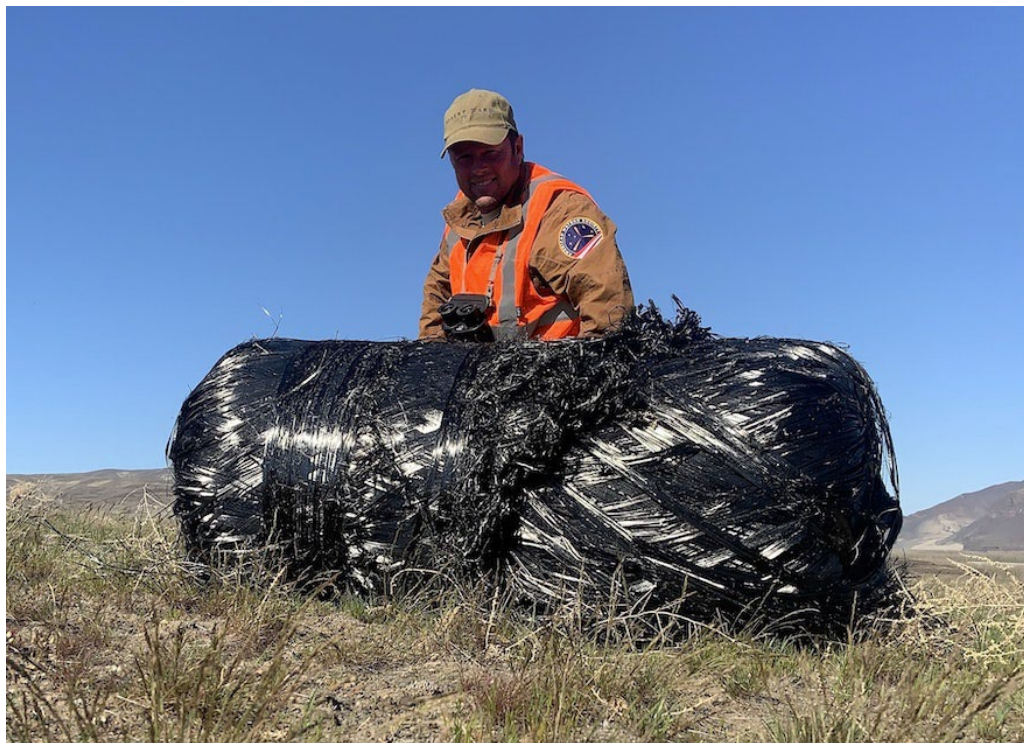
2021年3月 米国ワシントン近傍で見つかった Falcon 9上段の推薬タンク
