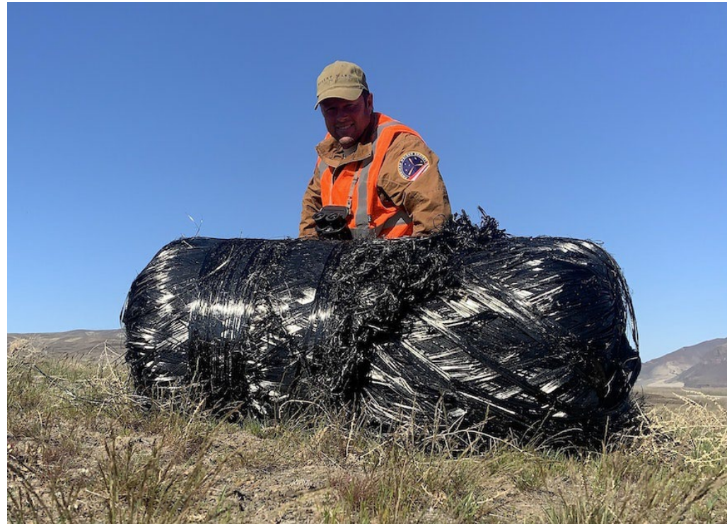
2021年3月 米国ワシントン近傍で見つかった Falcon 9上段の推薬タンク
