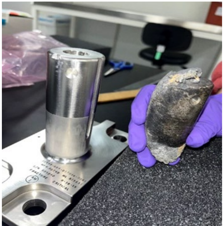
図 3.1-1 発見されたニッケル水素電池搭載用構造物の支柱（右）およびオリジナル形状（左） 9
