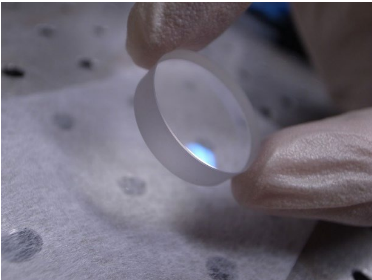
「ハイブリッド・リオ」マスクのマスク基板（マスク加工前）
