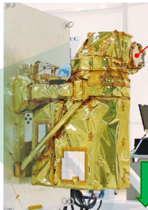
光衛星間通信機器光学部 (衛星外部搭載機器)
