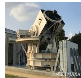
NICT沖縄電磁波技術センター内の光地上局に設置されている1m光学望遠鏡とJAXAチェックアウト機器
