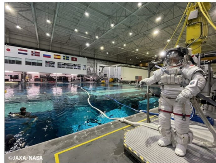
船外活動ユニット(Extravehicular Mobility Unit: EMU)を着用してのNBLでの船外活動訓練 (継続的に実施)
