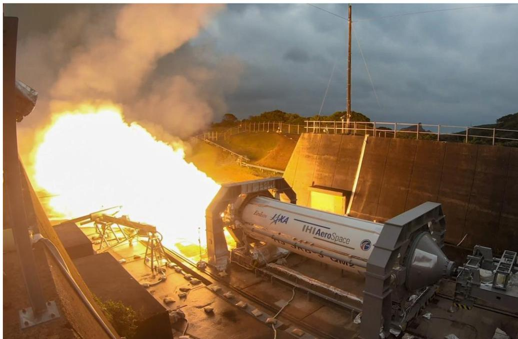
SRB-3実機大地上燃焼試験
