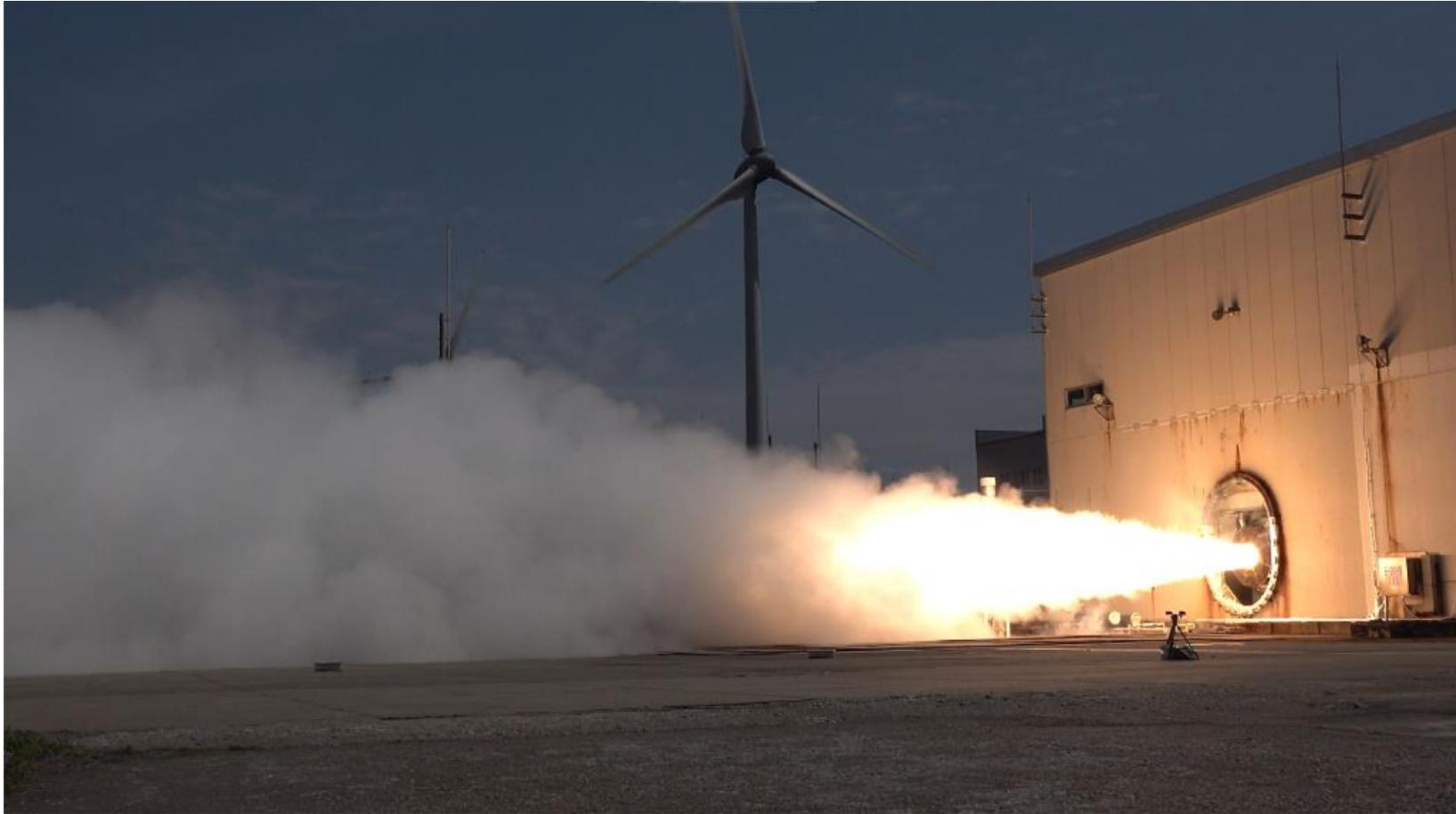
3段モータ地上燃焼試験
