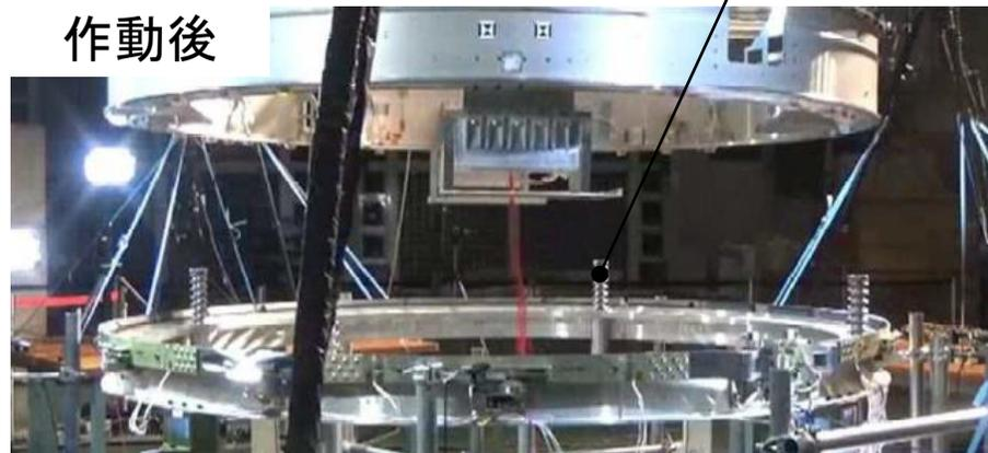
段間分離機構作動試験
