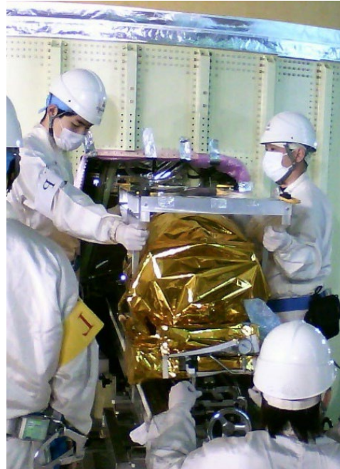
2023年2月4日 2段ガスジェット装置機体取付
