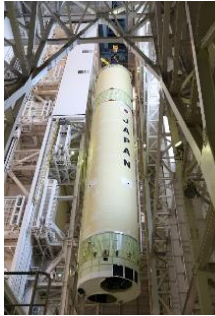
2024年12月24日 1段機体射座据付け (VOS※1)
