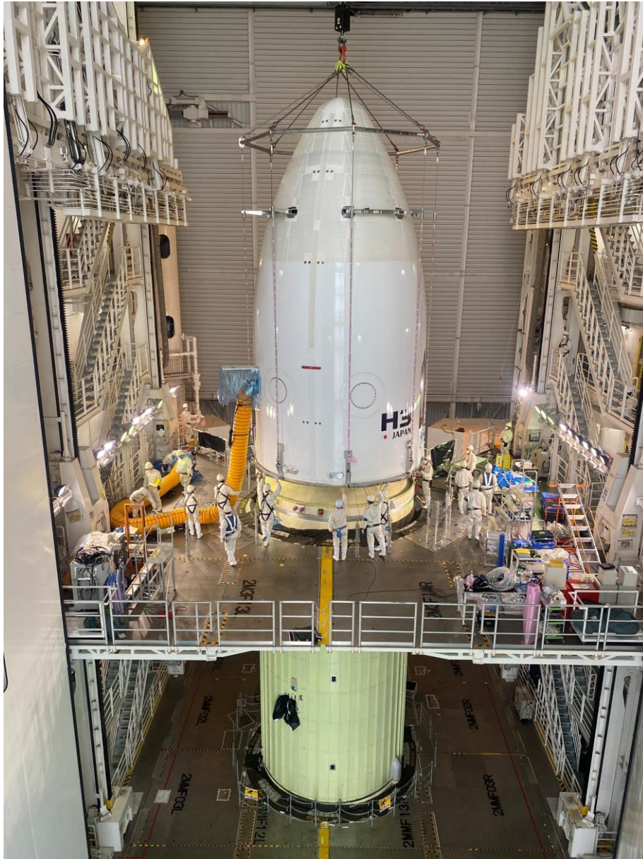
写真⑧ H3ロケットに結合される衛星フェアリング
