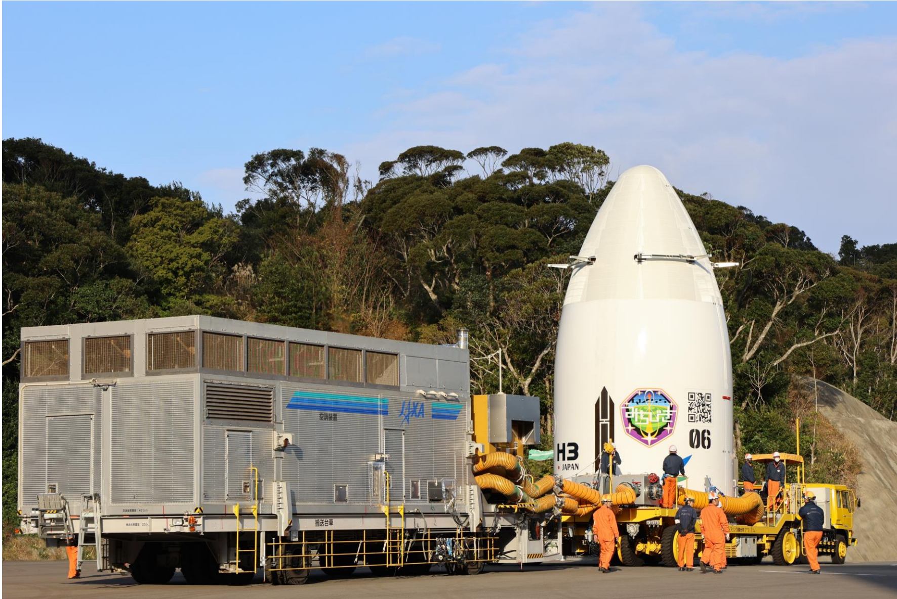
写真④ 衛星フェアリング運搬台車と空調車の接続準備完了。
