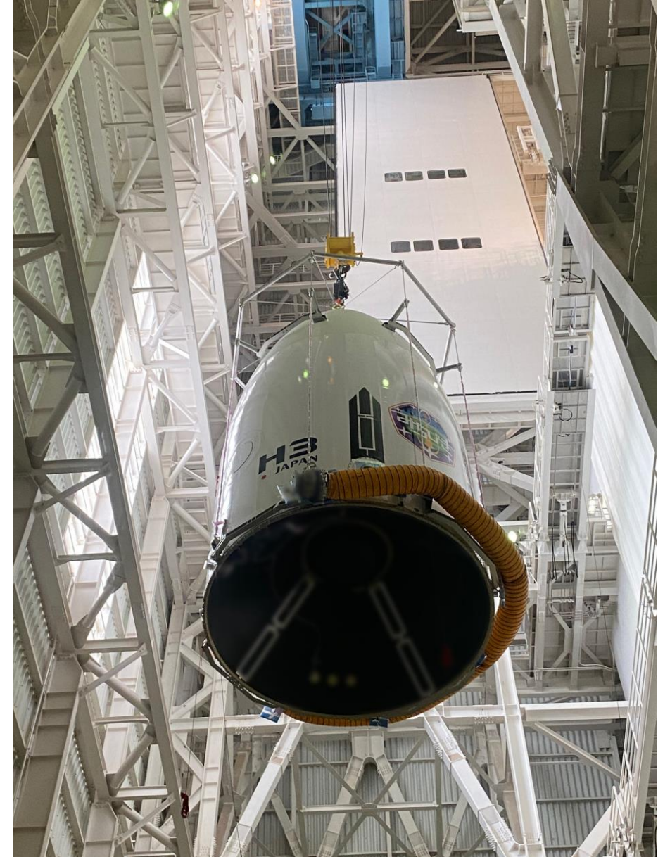
写真⑦ ロケット組立棟（VAB）内で吊り上げ中の衛星フェアリング
