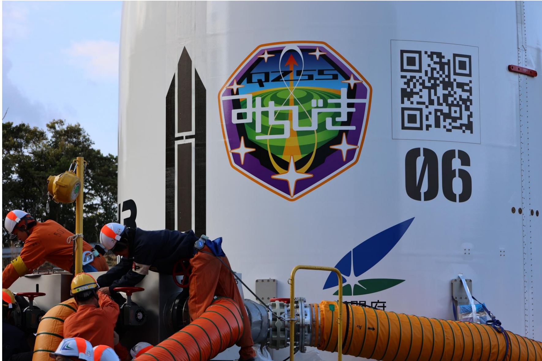
写真③ 衛星フェアリング運搬台車と空調車の接続準備中。
