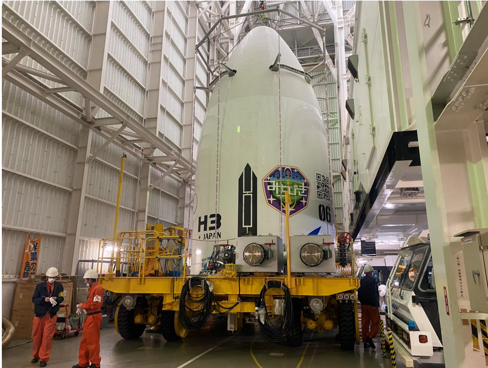
写真⑥ ロケット組立棟（VAB）内で吊り上げ準備中の衛星フェアリング
