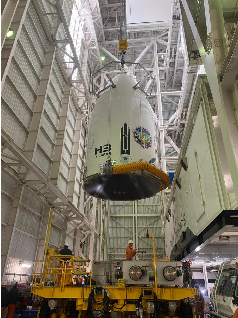
写真⑦ ロケット組立棟（VAB）内で吊り上げ中の衛星フェアリング
