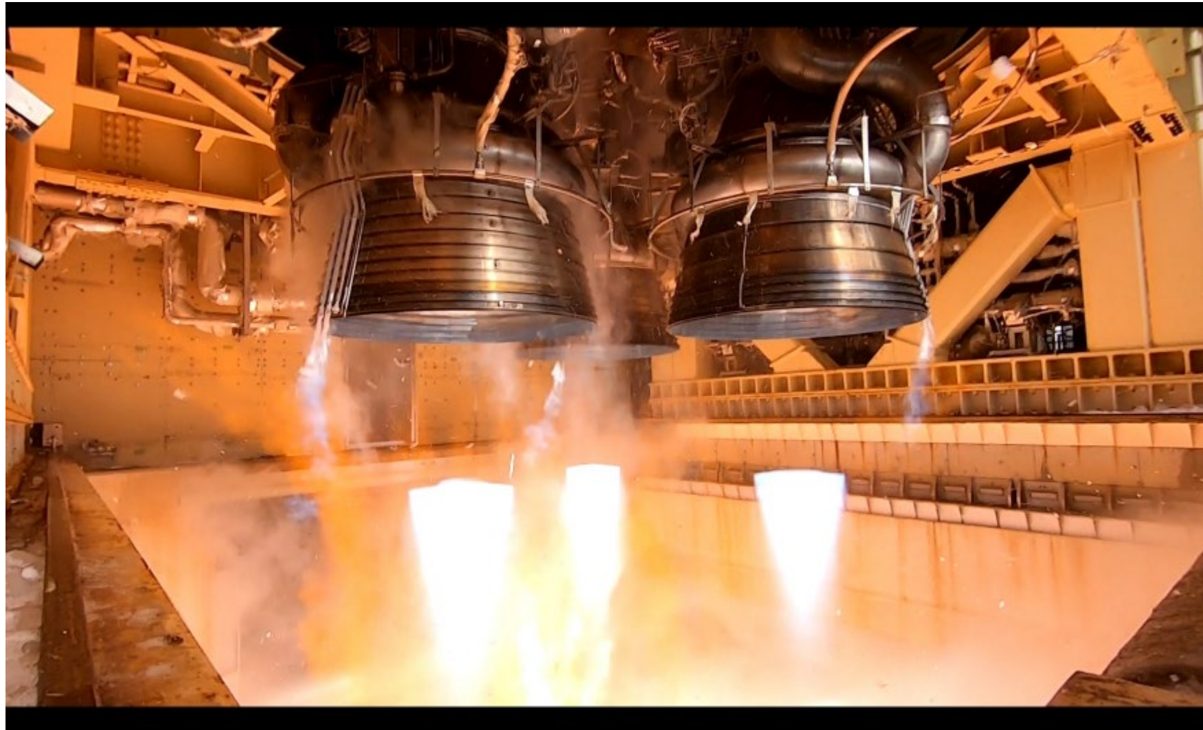
H3ロケット用第1段厚肉タンクステージ燃焼試験（BFT）の様子（2020年1月17日）
