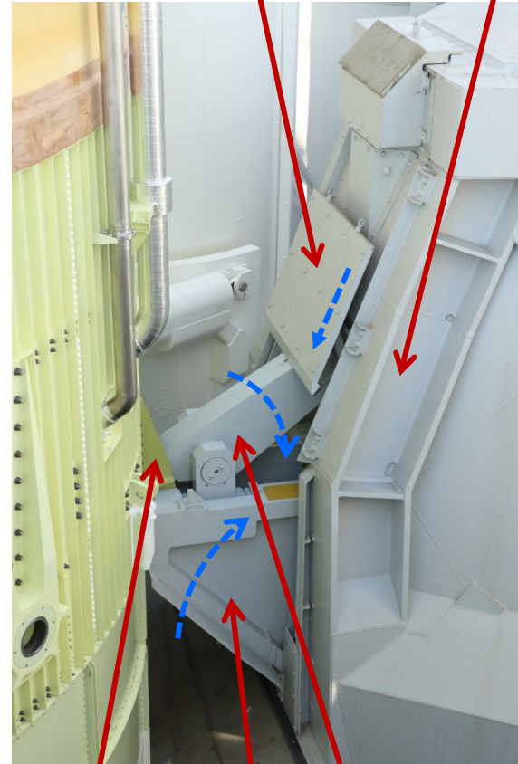
射座金具（機体） ホールドダウン機構 発射固定台
