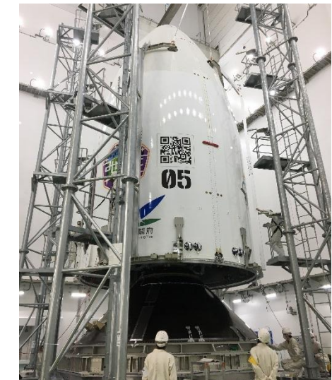
11月28日 みちびき5号機をフェアリングに収缶
