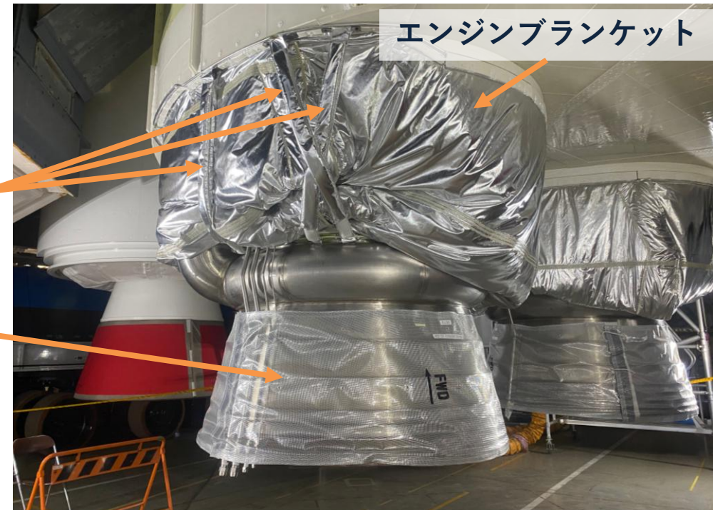
9号機の振動抑制ベルト取付け状態
