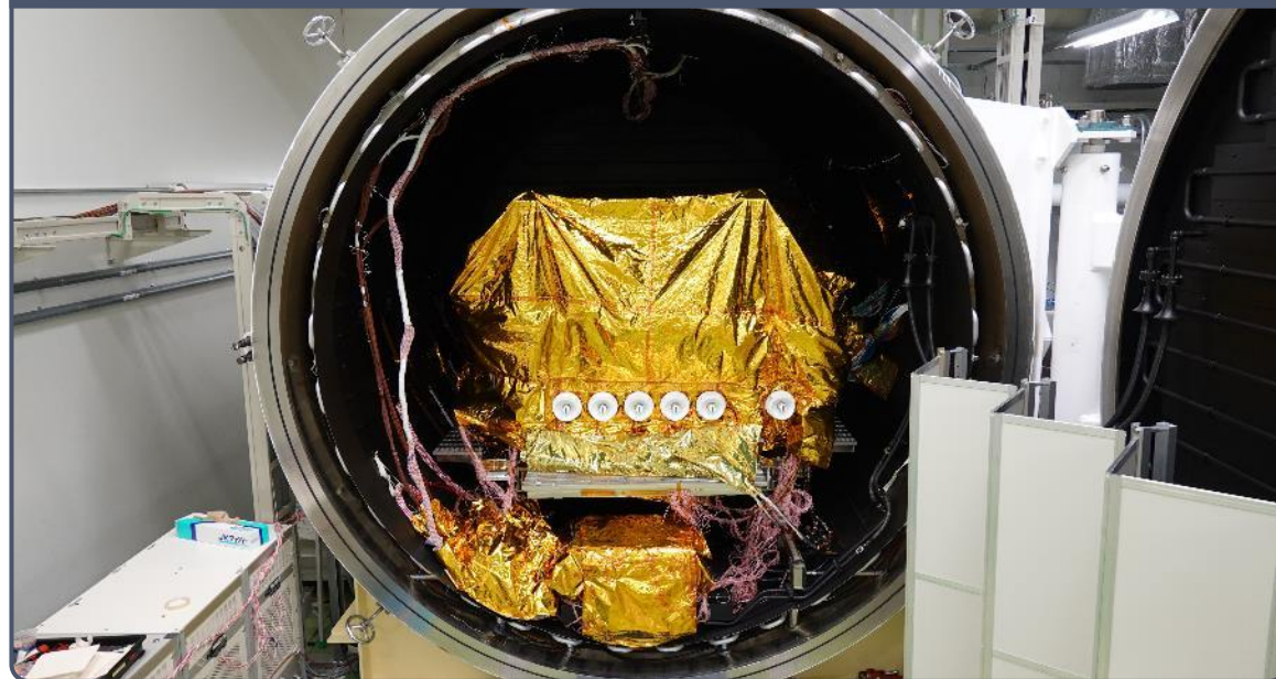
宇宙空間を模擬した熱真空試験
