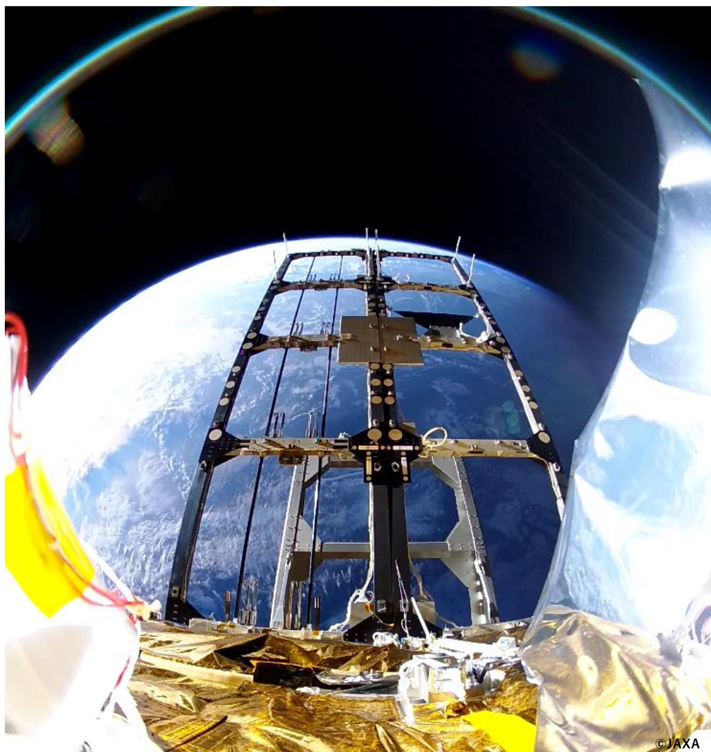
図 DELIGHTに搭載した360°カメラで撮影したパネル展開後の画像
