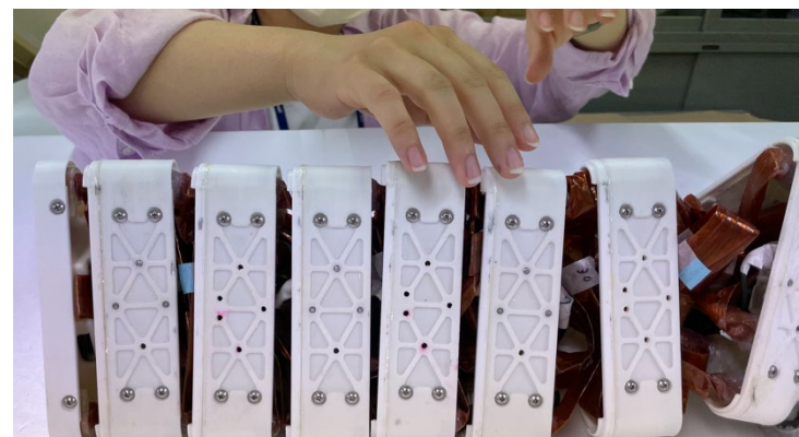
インフレータブル部材の折り畳みと収納
