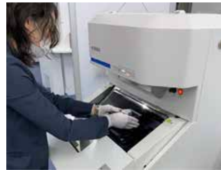
化学組成分析を行う蛍光X線分析装置(©リガク, ホリバ)
