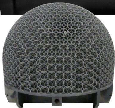
着陸脚：関節方式ではなく、「ポーラス金属」が潰れることで、着地時のエネルギーを吸収する方式. 3Dプリンタで製造
