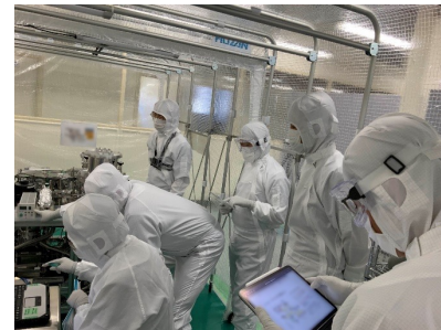
ウーメラの仮設分析設備内でのガス採取作業の様子(リエントリ6時間後)
