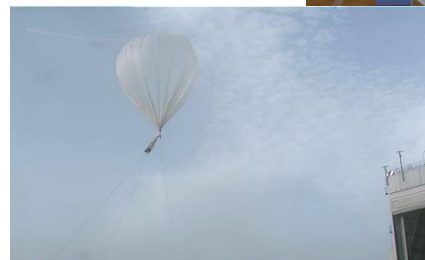
体積2,000m 3 の気球を用いた 放球法の地上試験(2022年)
