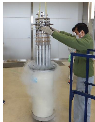
マイナス269℃で上空の大気を固化する試料容器
