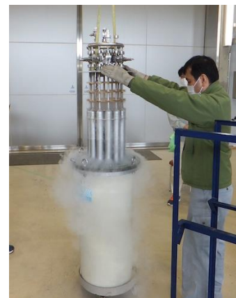
マイナス269℃で上空の大気を固化する試料容器 (過去の実験実施時に撮影された写真)
