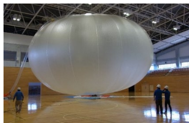
体積2,000m 3 の気球の 地上試験(2017年)
