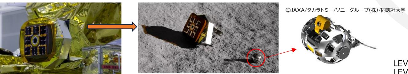
LEV-2(愛称SORA-Q)が月面で撮影して近距離通信によりLEV-1に送信、LEV-1が地球へ直接送信することで得られた月面上のSLIM
