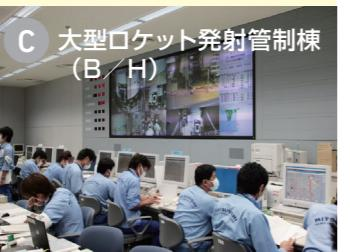
射点から500mの地下12mに発射管制室があります。ロケット打ち上げまでの一連の作業に対する指揮・監督などを遠隔操作で行うとともに、総合指令棟に必要な情報を伝達します。
