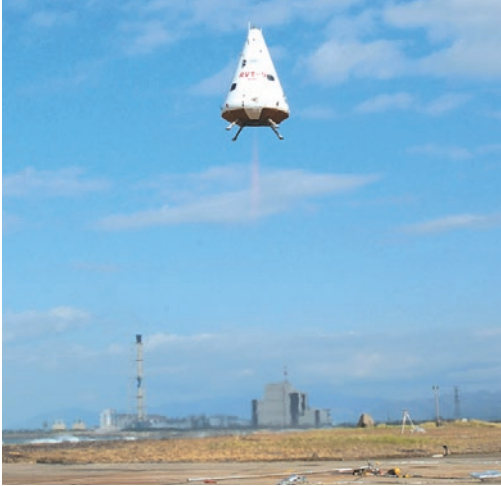
再使用ロケット実験機の垂直離着陸実験(2003年10月)
