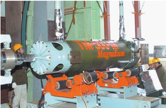
マグナリウム入り固体コンボジット推進薬を用いる固体モータの技術実証試験(2006年12月)
