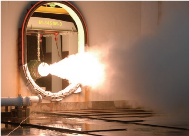
イプシロンロケット技術要素試験(M-34SIM-3モーター大気燃焼試験)
