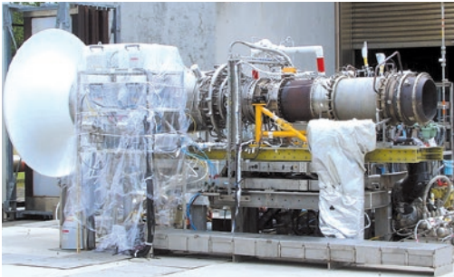
エアターボラムジェットエンジンの燃焼実験(2003年8月)
