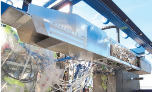
小型予冷ターボジェットエンジンの燃焼試験(2007年11月)
