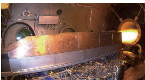
複合サイクルエンジン(エッジクエットモード)の作動実験
