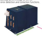
CPV型バッテリー実験装置 小型軽量化を可能とするCommon Pressure Vessel型バッテリの性能 を軌道上で評価
