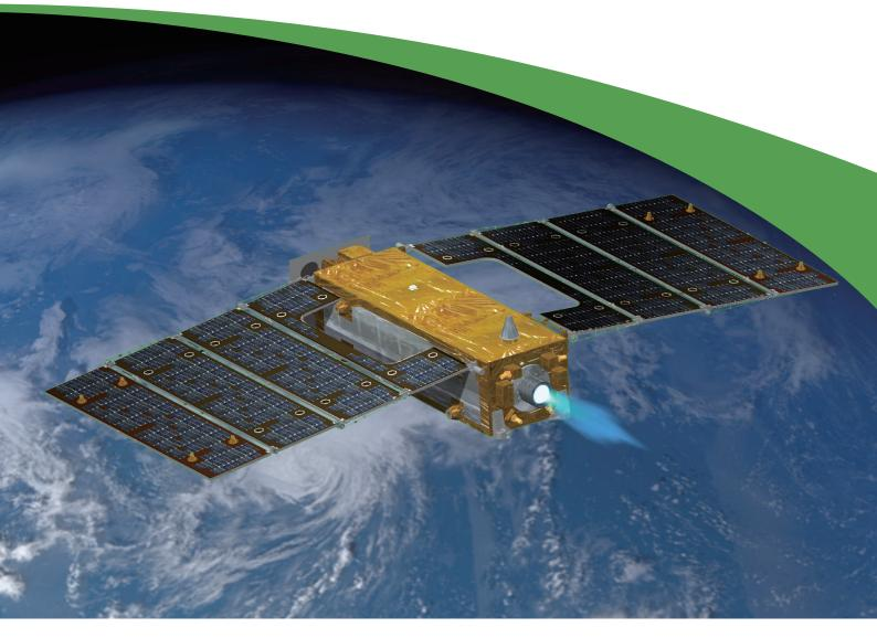
軌道高度にして300kmより低い軌道は「超低高度軌道」と呼ばれ、これまでの人工衛星にとって未開拓の軌道領域です。この超低高度軌道を利用する最初の地球観測衛星が超低高度衛星技術試験機(SLATS: Super Low Altitude Test Satellite)です。超低高度での飛行を可能にすることで、地上により近くなるため、光学画像の高分解能化、観測センサ送信電力の低減、衛星の製造・打ち上げコストの低減などが期待されています。
