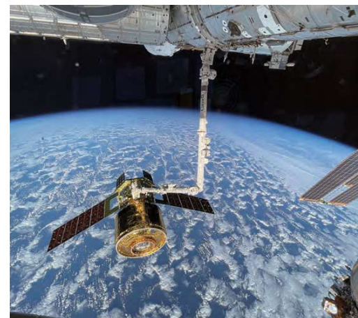
HTV-X1 captured by the International Space Station's robotic arm (SSRMS) / ISS のロボットアーム (SSRMS) に把持された HTV-X1 号機
