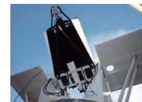
60cm telescope for the direct imaging of the target / 60cm望遠鏡による大型の軌道上物体の直接観測(長野県入笠山光学観測施設)
