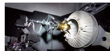
SATdyn / 軌道上サービス技術実証プラットフォーム (非静止デブリの捕獲・把持等をシミュレーションで実証する設備)
