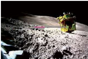
Image of the SLIM on the Moon taken and transmitted by the transformable Lunar Excursion Vehicle (LEV-2) "SORA-Q" / 変形型月面ロケットLEV-2「SORA-Q」が撮影・送信した月面上のSLIM画像 © JAXA/TOMY Company, Ltd./Sony Group Corporation/Bosch University © JAXA タカトミレーニールグループ/博志社/同友社/同友社
