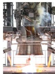
H3ロケット第1段エンジンの燃焼試験
