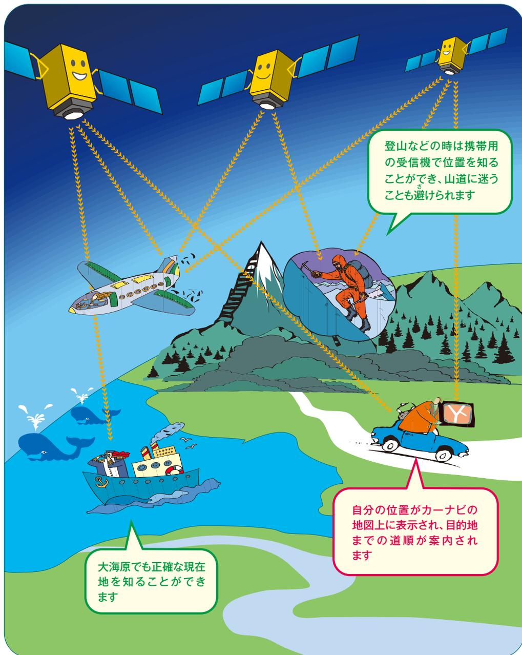
ナビゲーションシステムとは、自分が今いる場所を特定し、目的地までの最適なルートを案内してくれるシステムです。主に全球測位衛星システムを使って位置を調べ、地図と組み合わせてルートを計算します。全球測位衛星システムとは、人工衛星（測位衛星）を利用して地球上のどこにいても正確な位置を測るしくみのことです。このシステムでは、複数の測位衛星から送られる電波を受信し、その情報をもとに自分の位置（緯度・経度・高度）を計算します。特に、4つ以上の衛星からの信号を受け取ると、より正確な位置を知ることができます。
