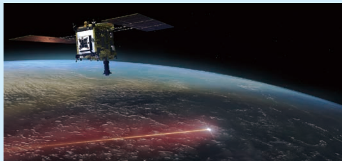
▲「はやぶさ2」は地球の近くまで戻り、サンプルが入ったカプセルだけを切り離して大気圏へ再突入させ、その後、本体は他の天体へと向かった。(イメージ図)
