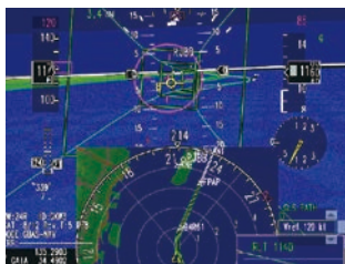
▲トンネル型誘導表示の例
