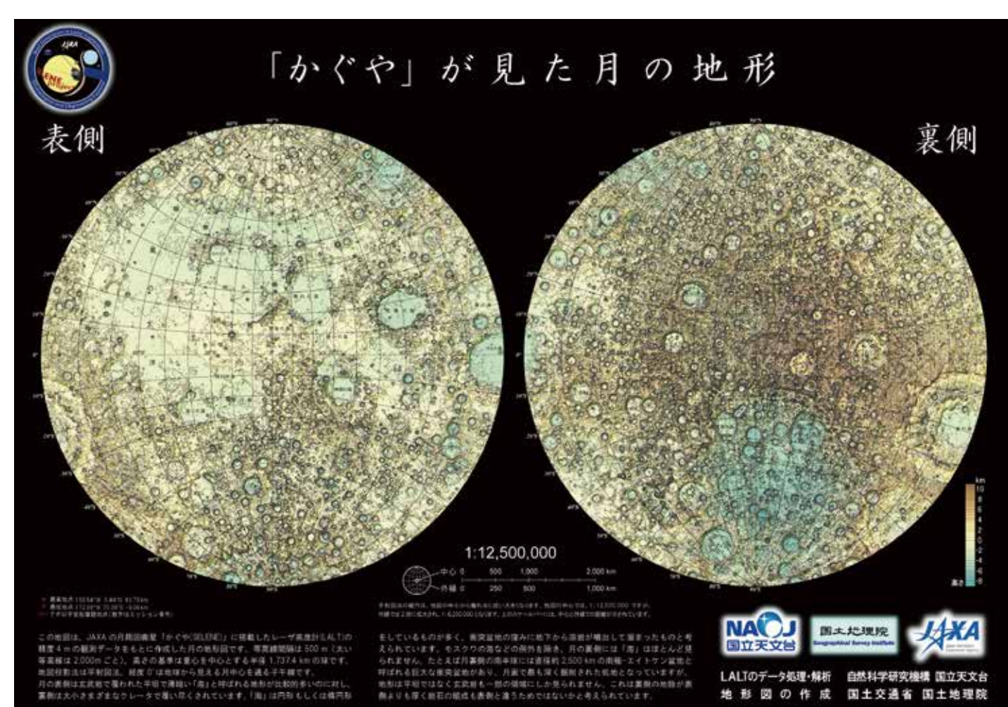
月周回衛星「かぐや(SELENE)」に搭載した レーザ高度計(LALT)の精度4mの 観測データをもとに作成した月の地形図
