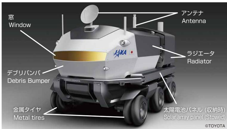
有人と圧ローバーの外観 (Exterior view of the Pressurized Rover)
