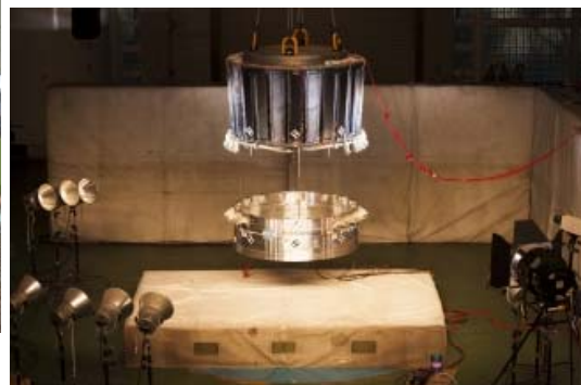
2・3段分離試験(平成24年度JAXA相模原)
