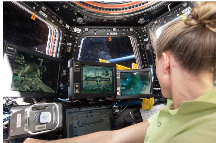
「こうのとり」を把持する際に使われるキューポラのロボットアーム操作卓（4号機到着前の軌道上訓練） （NASA提供）
