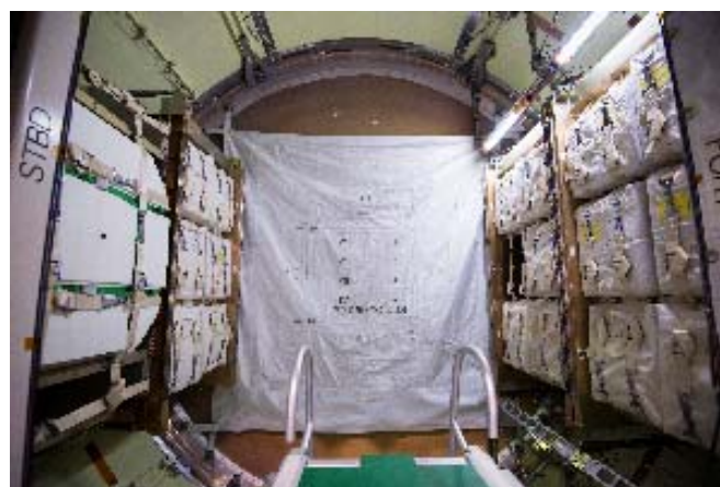
図 2-5 「こうのとり」7 号機の与圧部に搭載された輸送物資（JAXA）
