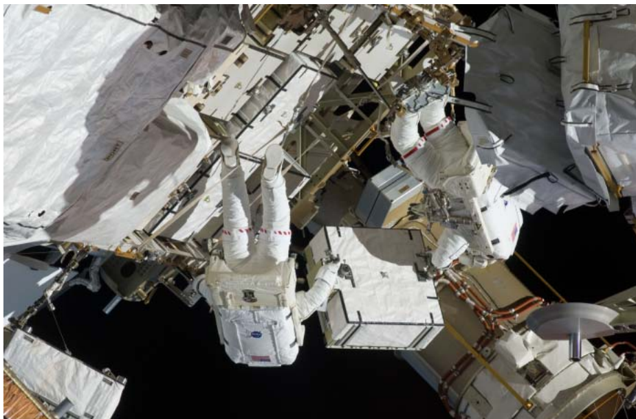
図 5.2-8 STS-127 ミッション時に行われた船外活動によるバッテリー交換作業の様子（NASA）
