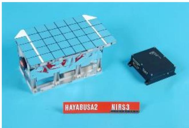
3 $\mu$ m帯を含む赤外線スペクトル:小惑星表面の鉱物の分布を調べる
