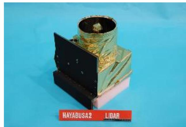
30m~25kmの範囲で、小惑星と探査機との距離を測定する
