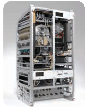
ESAの先進閉ループ生命維持システム実験は、長期ミッション期間中の空気補給への宇宙飛行士作業を減らすための実験例である。
