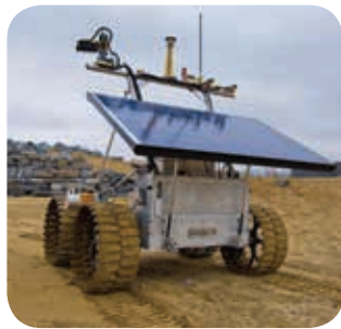
2台の探索車が、地上の模擬環境下で高信頼自律移動ソフトウェアの技術実証をしている。(左側がK-REX、右がアルテミスJr./カナダ宇宙機関)
