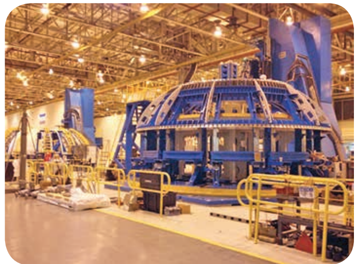
NASAミコード組立施設（ルイジアナ）の円形ドーム溶接ツールによって、12枚のパネルからSLS第1段ステージが組立てられる。
