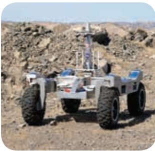
2台の探索車が、地上の模擬環境下で高信頼自律移動ソフトウェアの技術実証をしている。(左側がK-REX、右がアルテミスJr./カナダ宇宙機関)
