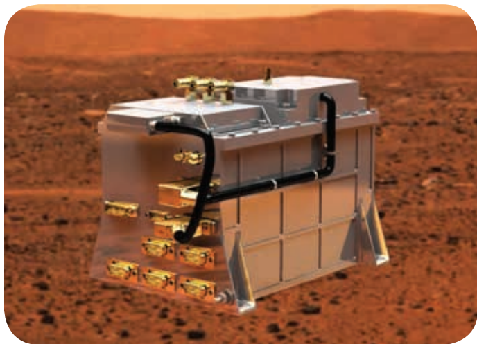
ASIは火星着陸地点環境の特性測定機器システムDREAMS（火星表面ダスト特性、リスク評価、環境解析器）を開発している。
