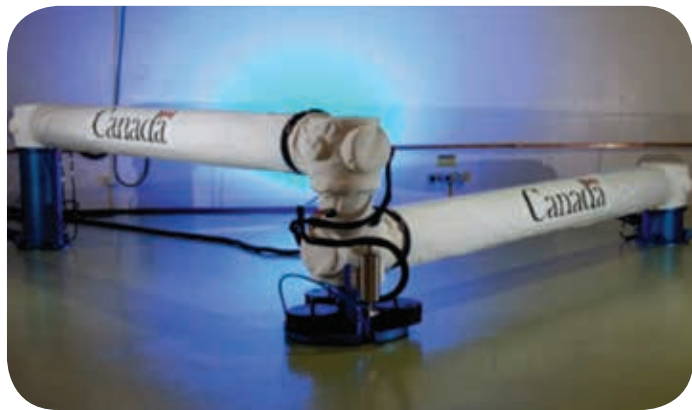
カナダ宇宙機関による次世代大型ロボットマニピュレータは、伸縮ブームを特色とし、オリオンのような将来の探査船の厳しい収納要求と打上条件を満足するだろう。
