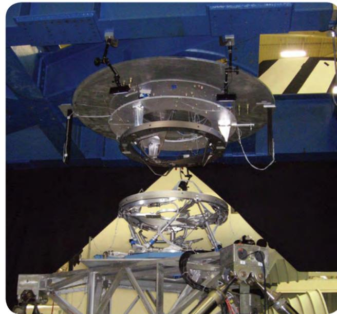
NASAのジョンソン宇宙センターで動的試験を実施中の、国際ドッキングシステム規格を満たすNASAドッキングシステムのプロトタイプ
