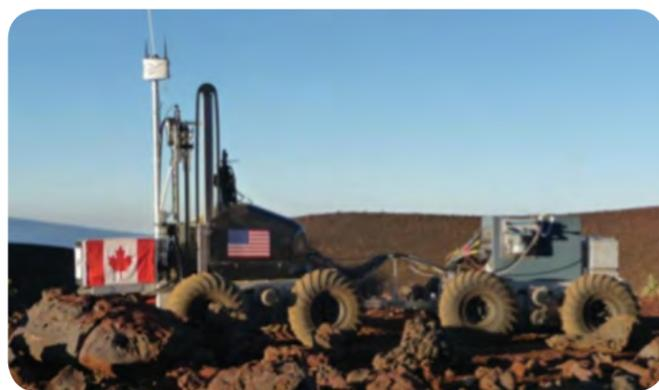
2010年にマウナケアに展開した地域でRESOLVE(レゴリス酸素抽出装置)パイロードとTridar航法装置を運搬するカナダのJuno Tandem Rover
