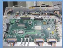
着陸レーダの信号処理システム
